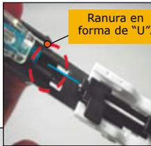
Deslice el soporte de la fibra lentamente hasta que se detenga.
