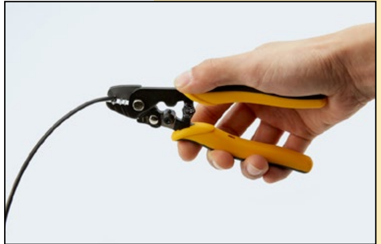
2. Pele el cable tipo drop con la herramienta pela cables
