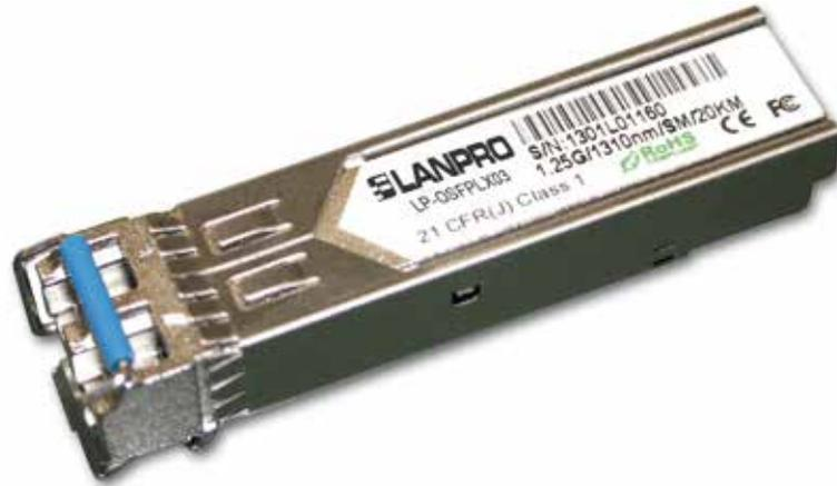
**LP-OSFPLX03DWA2 Transceptor SFP de fibra Monomodo LC simplex, DDM, 1000BASE-LX 9/125μm en Tx 1310nm/Rx 1550nm, WDM, hasta 20 Km**
