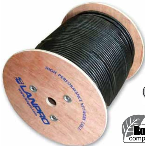
**Cable para redes LanPro Reliable® CAT 5e SF/UTP para uso en exteriores con conductores sólidos AWG 24 de cobre 100%, y con doble-blindaje de malla tejida de aluminio-Magnesio con cobertura de 60% sobre película de aluminio incluyendo conductor de drenaje, chaqueta externa simple de Polietileno (PE) e hilo de rasgar en carrete de 305 m (1000pies).**
