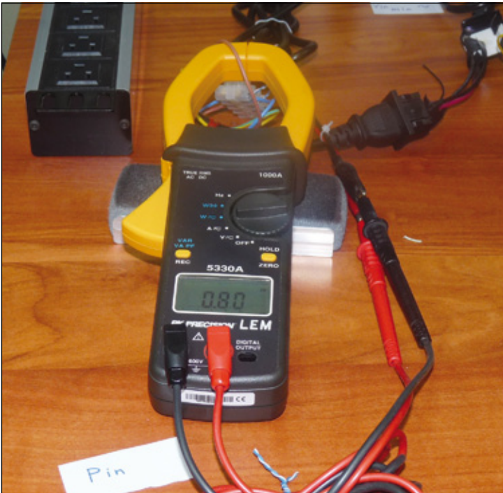
Figura 8. Factor de potencia medido: 0.80
