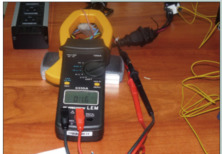
Figura 5. Corriente de línea medida: 1.6 Ampere AC
