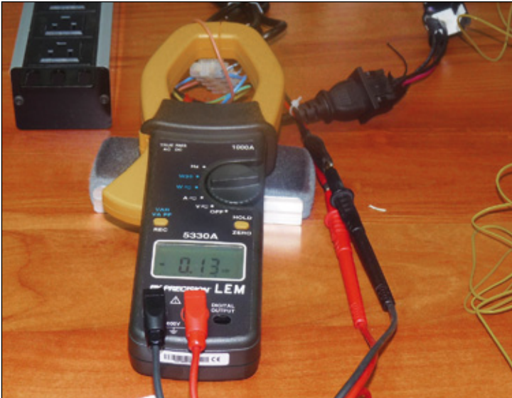
Figura 6. Potencia Real medida = 0.13 KW
