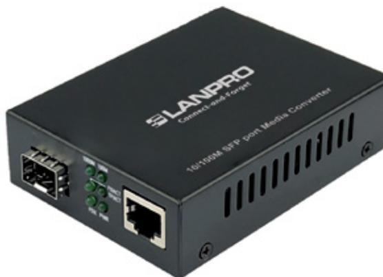
**LP-CHOSF21001 Chasis para Convertidor de medios con un puerto SFP de 10/100M con fuente de poder externa**
